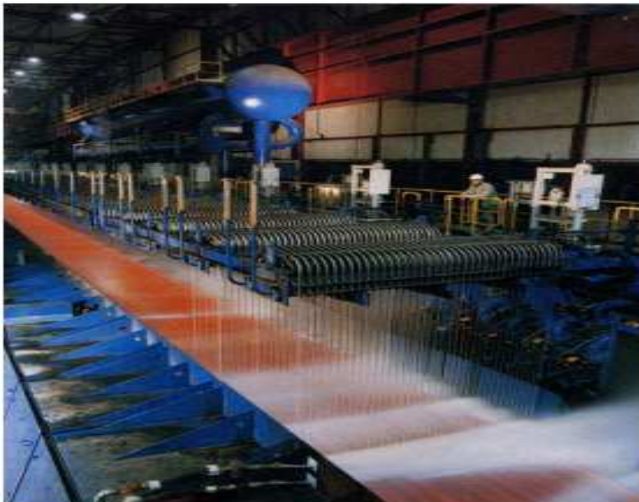
Figure.1.1. Refroidissement par jets d'eau [12].
