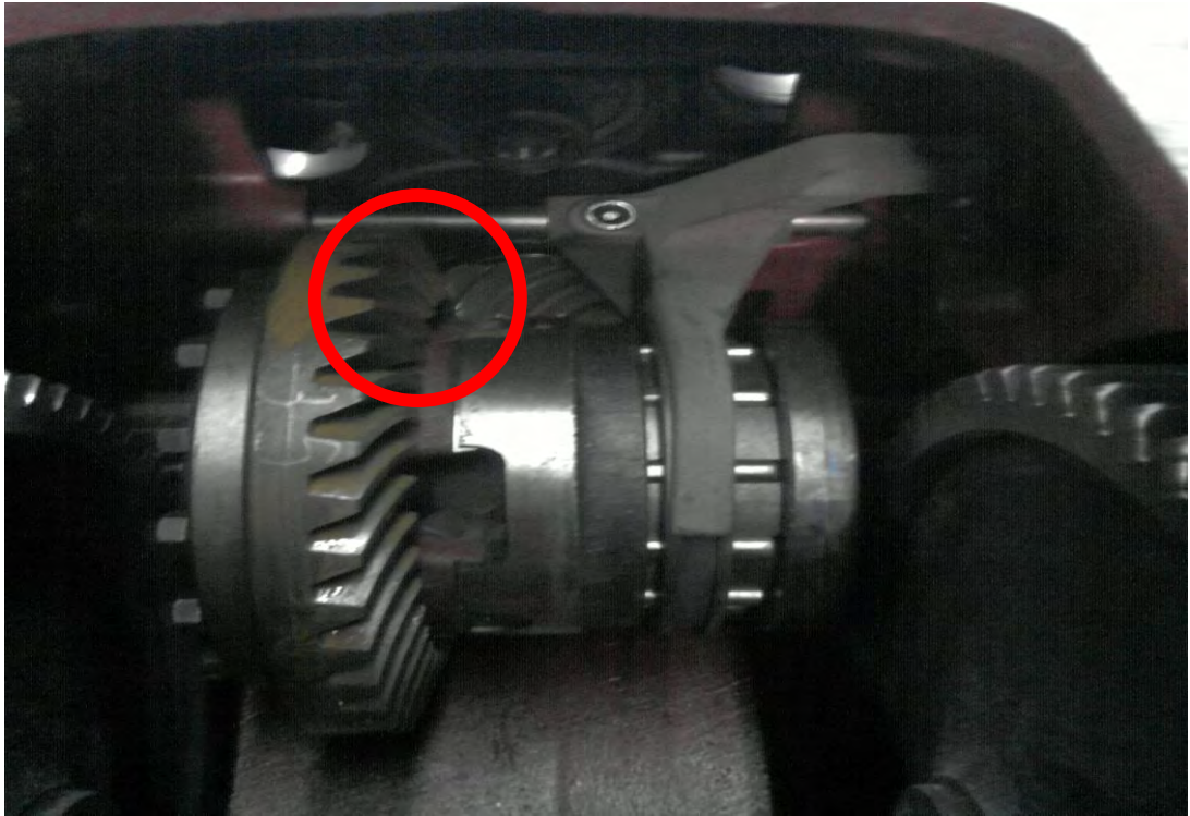
Figure 3 : Illustration du couple conique dans la boîte à vitesses
