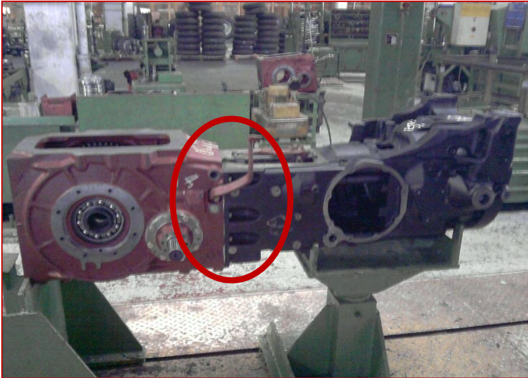
Figure 1 : La boîte à vitesse TW55.4 (pond avant et pond arrière)
