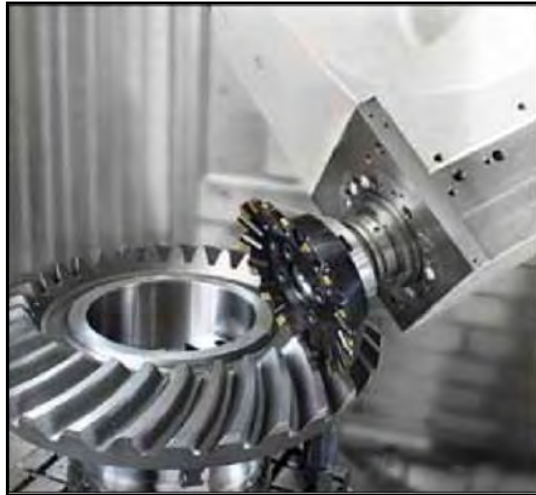
Figure I- 16 : Outil de taillage de la machine CNC
