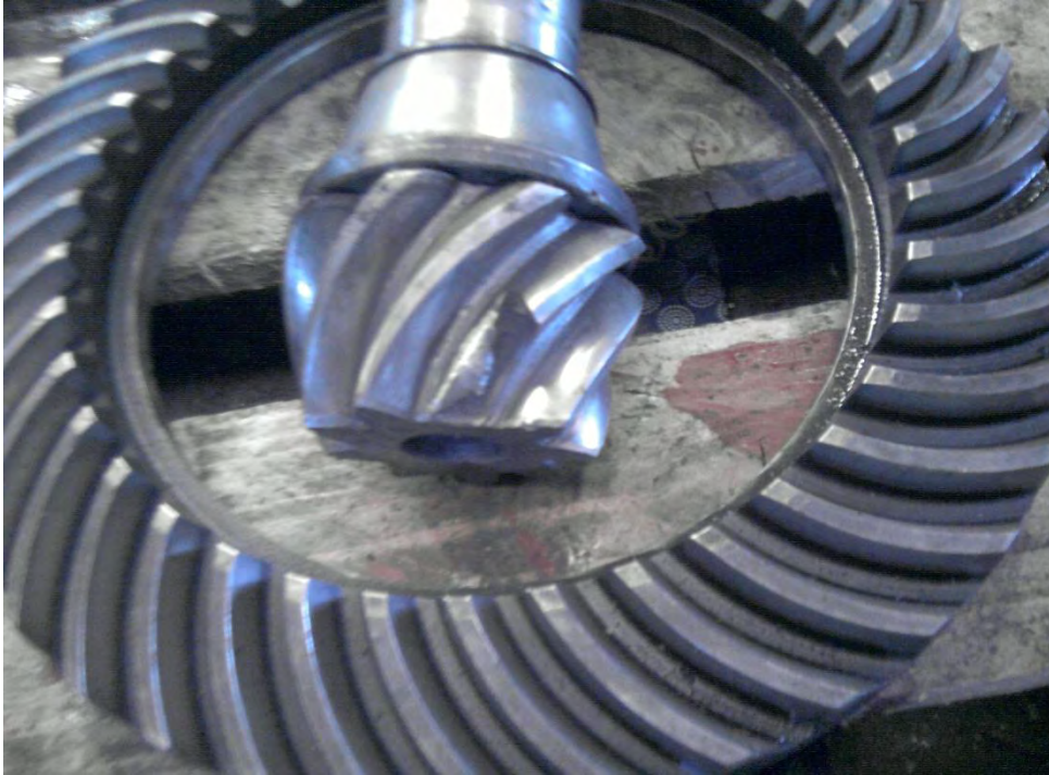
Figure 6 : Pignon endommagé après fonctionnement
