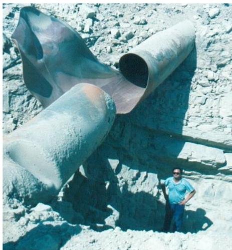
**Figure I.2 : Eclatements avec rupture franche de la canalisation [2]**
