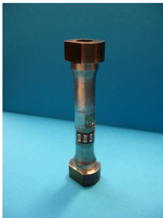
Figure II.3 : Eprouvette d'essai de traction
