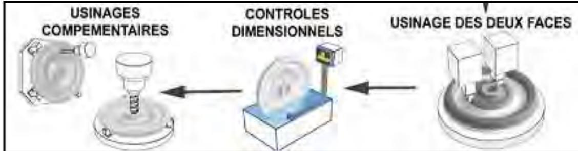
Figure II-11 des usinages supplémentaires sur les roues [15]
