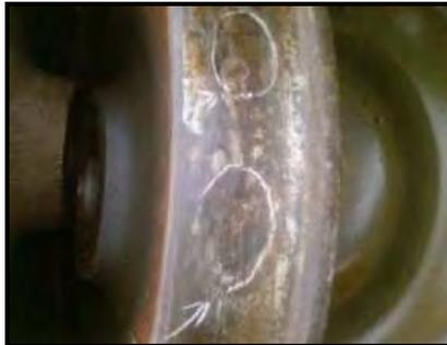
Figure III-2: méplat sur la table de roulement (photo prise à l'AMF)
