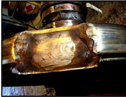
Figure III-11: Fissuration parallèle à la table de roulement ayant conduit à la perte d'un secteur de roue[21]
