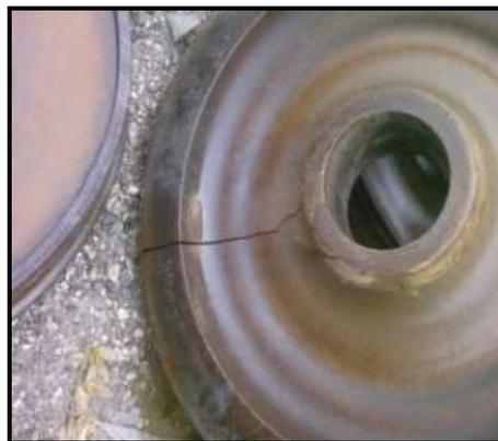
Figure III-6: toile fissurée (photo prise à l'AMF)
