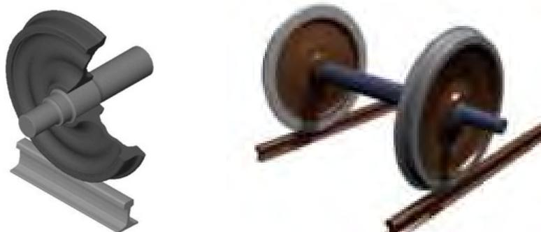
Figure II-4: montage des roues avec axes.[22]
