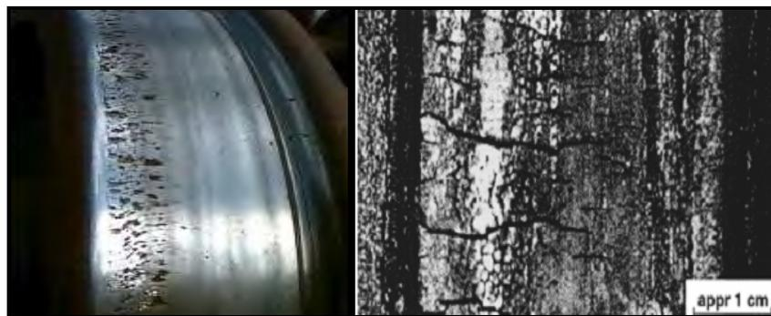
Figure III-4: écaillage d'une roue et fissures amorcées à la surface de contact d'une roue.
