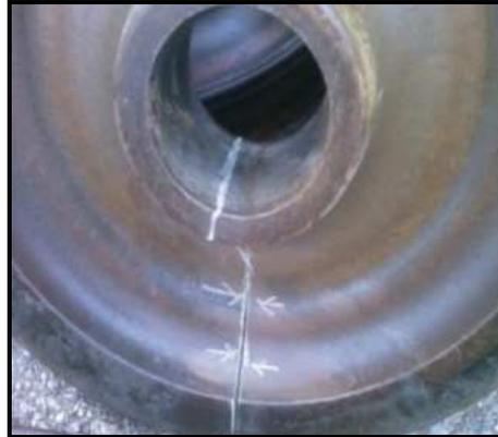
Figure III-7: rupture de la toile (photo prise à l'AMF)
