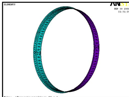
Figure V-24: l'élément de contact (surface d'épaisseur nulle autour de la roue)
