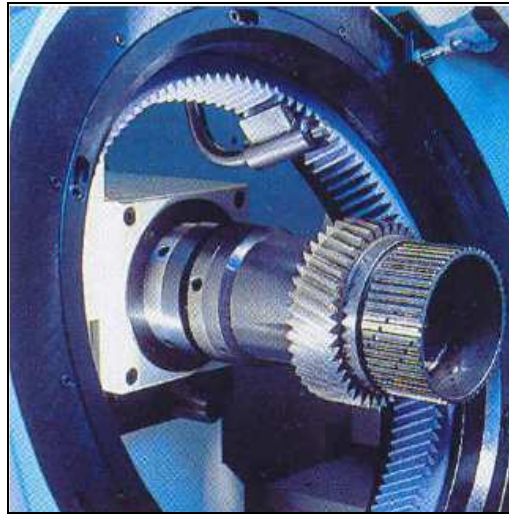
Figure I-35 : Principe du rodage de dentures (source Pfauter).
