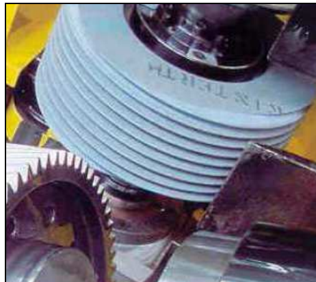
Figure I-34 : Rectification de dentures à la meule-mère (source Samputensili).
