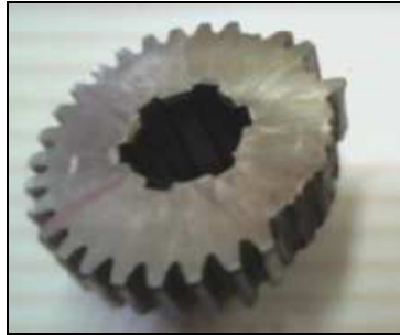
Figure II-18 : Rupture par fatigue.
