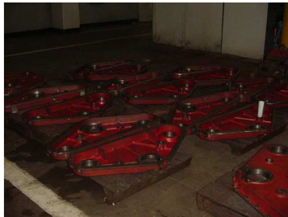
Figure IV-6 : Usinage des carters directement après l'arrivée de la fonderie.
