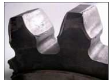
Figure II-26 : Déformation plastique par roulage des dentures.
