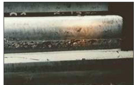
Figure II-19 : Rupture par écaillage
