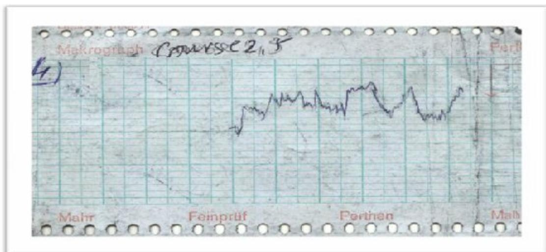
**Fig. IV.2. h)** profil de rugosité de plaquette revêtu avec les paramètres de coupe suivante :  $a = 0,2$  mm/tr,  $p = 0,2$  mm,  $V_c = 220$  m/mn,  $T = 60$  mn.
