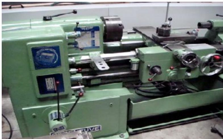
Fig. III.1 .tour parallèle conventionnel.
