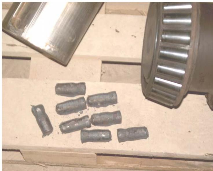
**Fig.V.25: Une photo réelle du roulement du réducteur après le démontage.**
