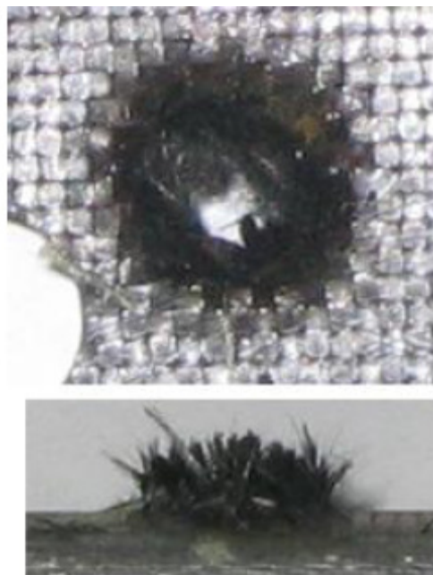
Figure 3: Défaut en sortie du trou
