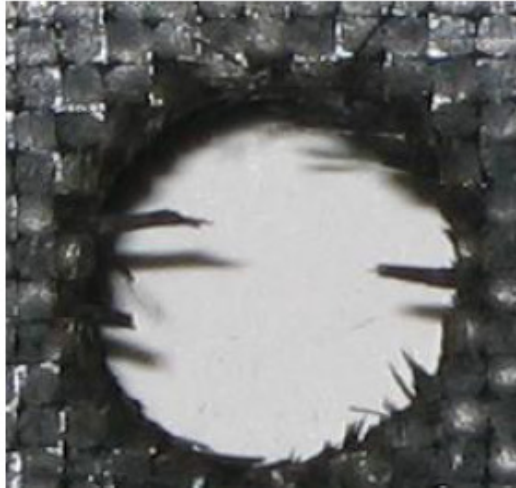
Figure 1: Défaut en entrée du trou
