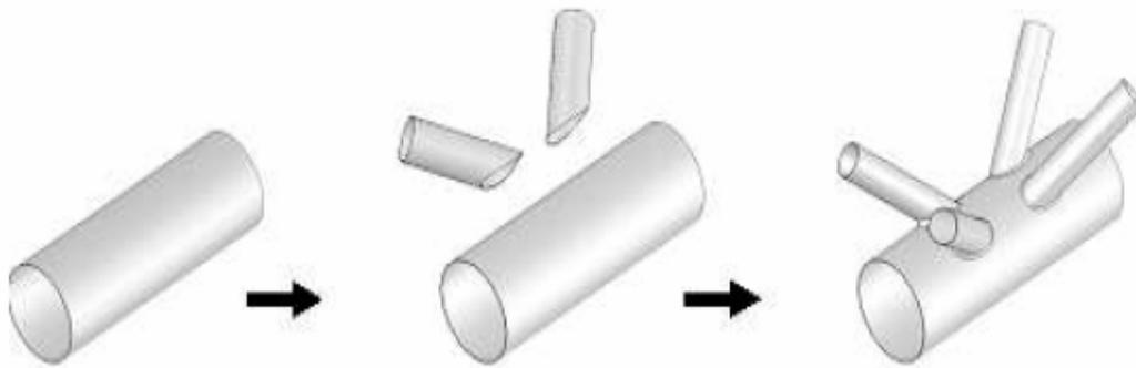
Figure I.19 : Technique d'assemblage traditionnelle
