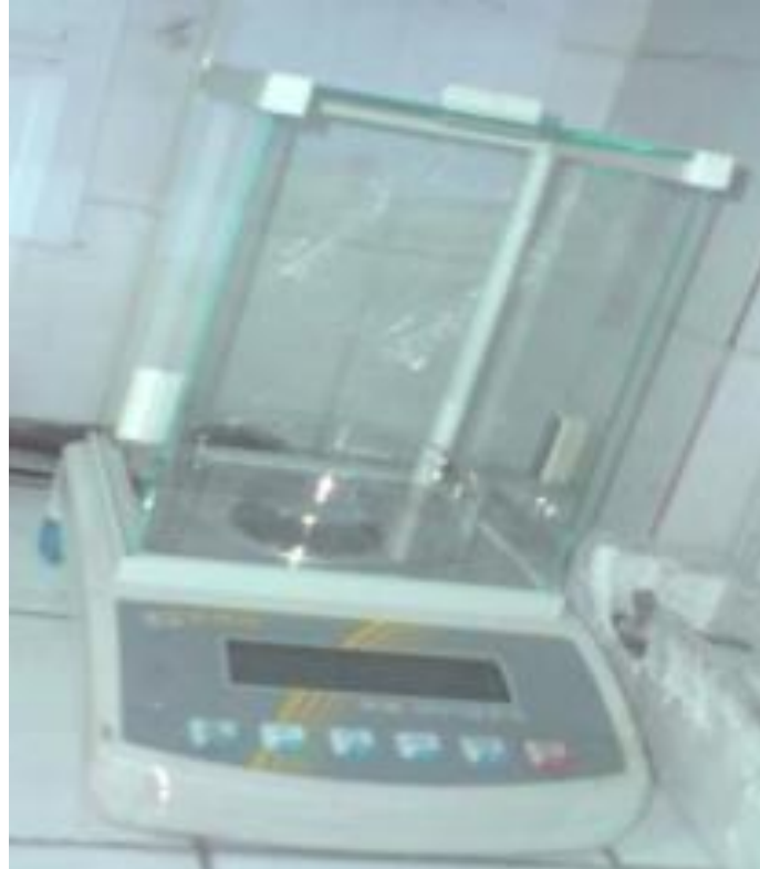
Figure II. 8. Microbalance précise à 10^{-5} g.
