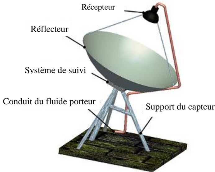
Fig. I.16 Capteur solaire à réflecteur parabolique [21].
