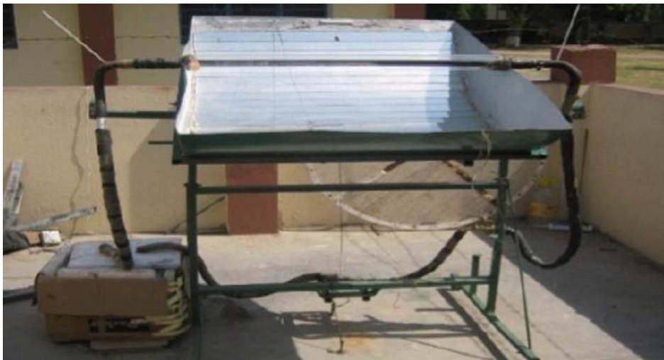
Fig. III.7 Le dispositif expérimental du capteur solaire parabolique utilisé par Sunil et al [109].
