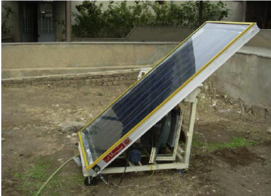
Fig. III.14 Le capteur solaire plan de l'expérience de Yousefi et al [129].
