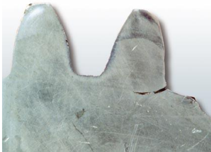
Figure III.8: Fissure de fatigue dans le filet de racine de dent.
