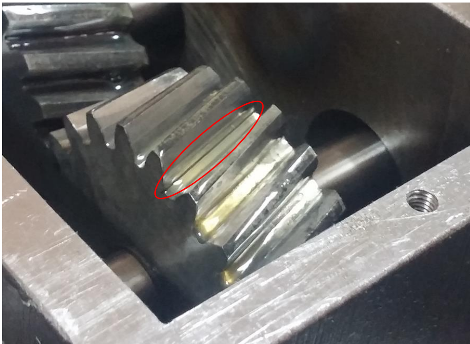
Figure III.9 : Fissure sur le pignon.
