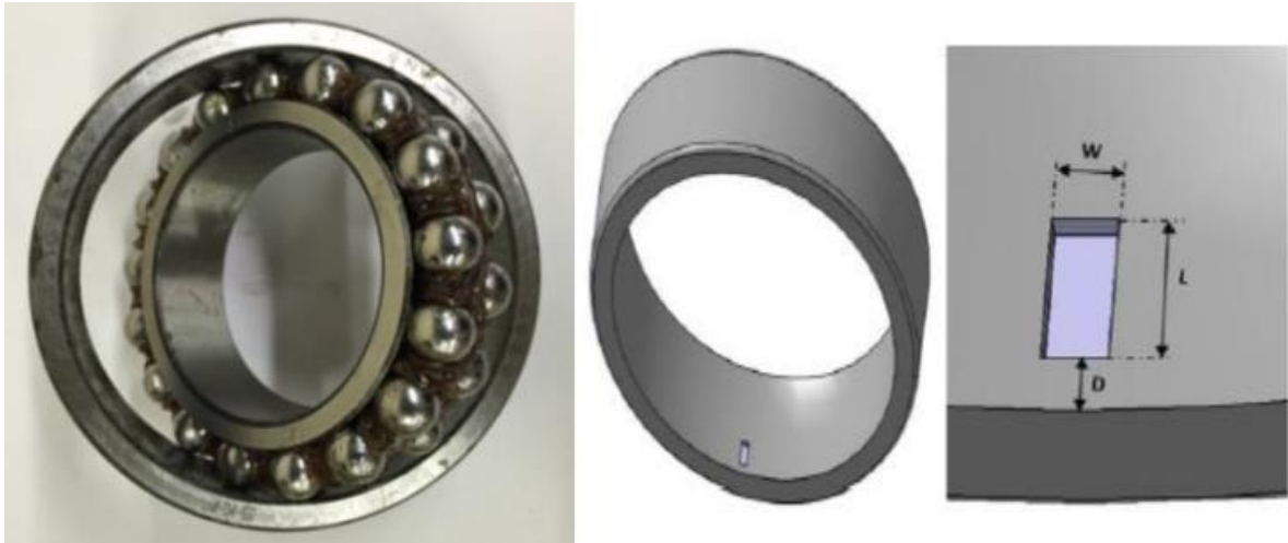
Fig. III. 2. Roulements SKF utilisé et (B) Modélisation de la bague extérieure avec défaut
