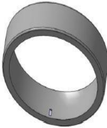
Fig. II. 7 : Roulement SKF utilisé Fig. II. 8 : Modélisation de la bague extérieure avec défaut
