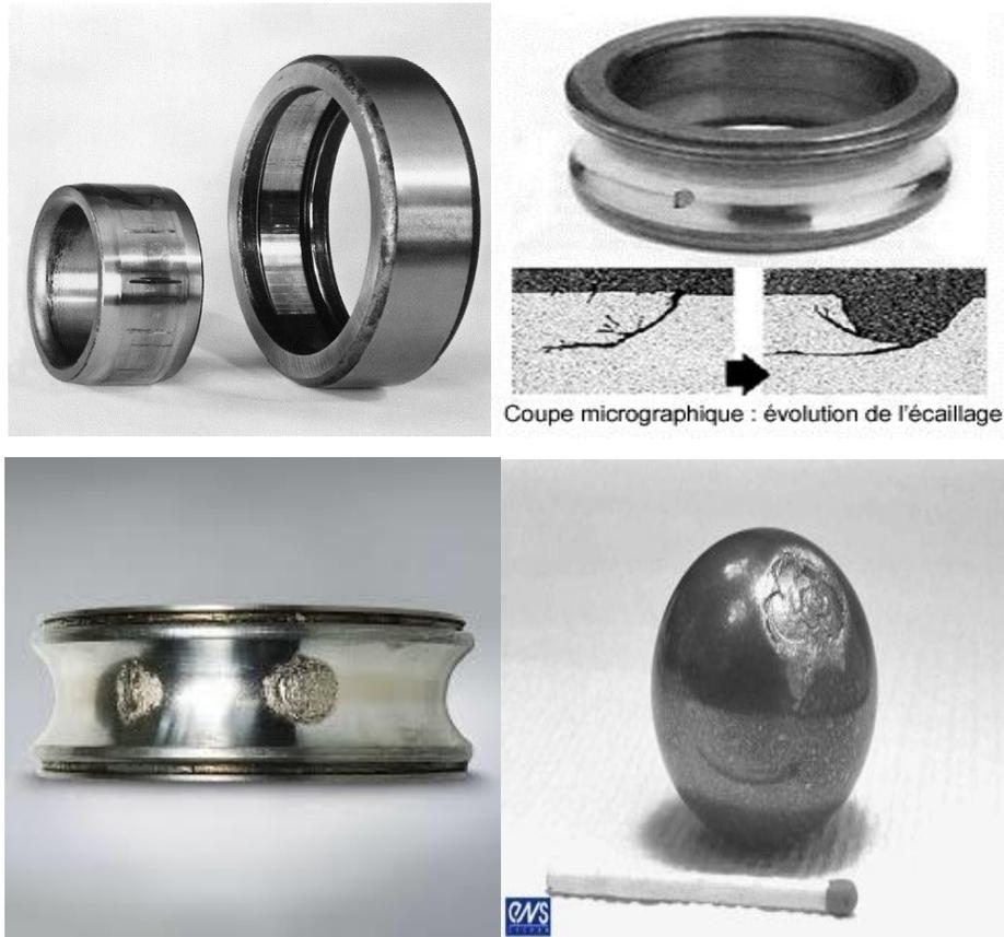
Figure 2.6. Défauts de roulements
