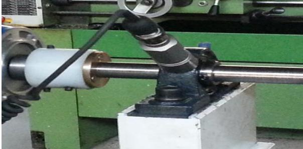
Figure 2.14. Position de l'accéléromètre
