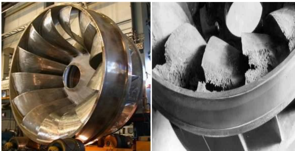
Figure (I.1) : Roue d'une turbine Figure (I.2) : Cavitation sur les aubes
