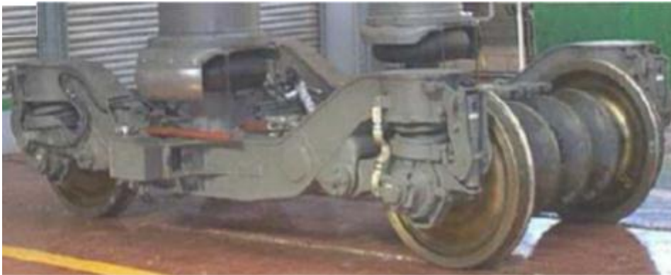
Figure I.1 : Un bogie du train.
