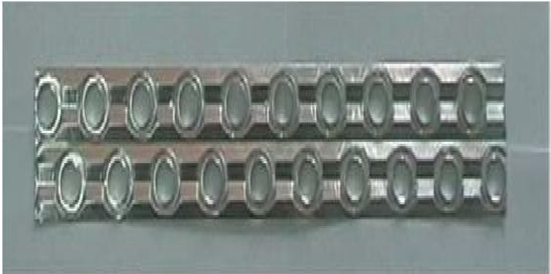
Figure (I.2.4) : tubes à ailettes plates pour échangeur de chaleur sans générateur de vortex [96]
