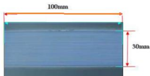
Figure VII.11 : Epreuve de traction en matériau adaptable à fibre active (AMF)
