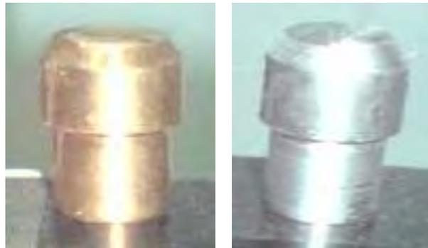
Figure II.5. (a) Pion en laiton et (b) en acier
