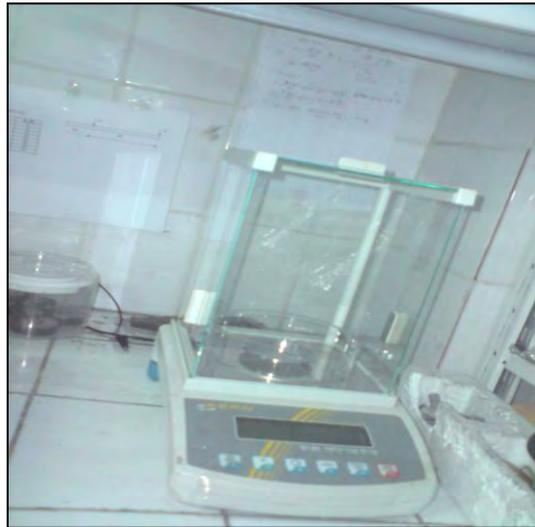
**Figure II.9. Microbalance de précision  $10^{-5}$  g**
