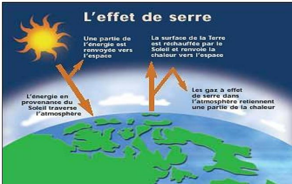
Fig. 2 - Schéma décrivant l'effet de serre
