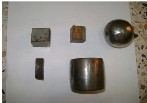
Figure IV.17. Échantillons pour la rugosité.
