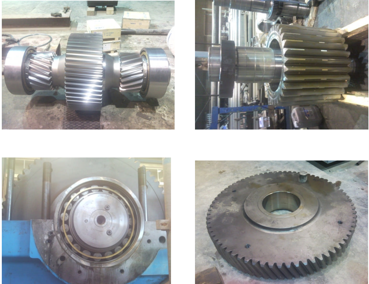
Figure IV.8. Image du réducteur flender DMGH 25.4 et éléments constitutants.
