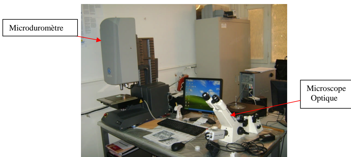
Figure IV.26. Microduromètre Tukon 2500 Wilson Hardness et Microscope optique Axio vert 40 Mot Zeiss assistés par ordinateur.
