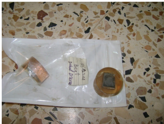
Figure IV.25. Echantillon de prélèvement de la micro-dureté des éléments de roulements
