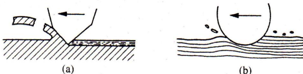
Figure III.2. Mécanisme de l'abrasion: (a) abrasion par effet de coupe; (b) abrasion par déformation.
