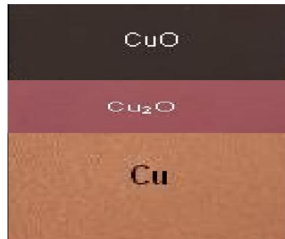
Figure I.10. Schéma de superposition des couches d'oxyde sur le substrat
