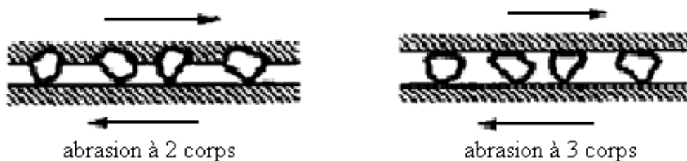
Figure III.1. Représentation schématique de l'usure abrasive à 2 corps et à 3 corps [13].
