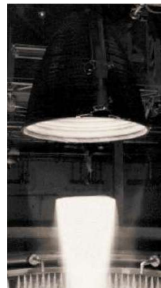
Fig. 1.17 - Réflexion de Mach Moteur Vulcain au banc d'essai [33].
