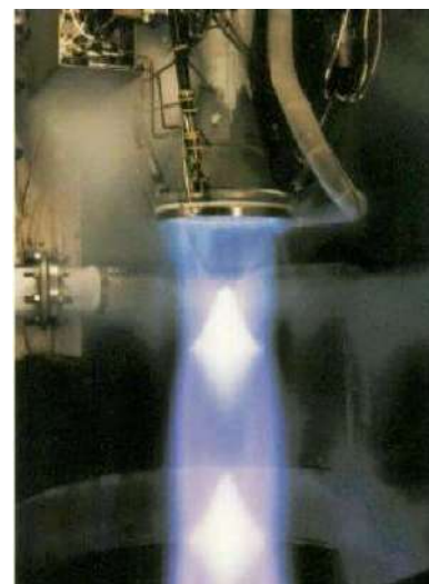
Fig. 1.14 - Réflexion régulière dans une tuyère réelle RL10-A5 [33].
