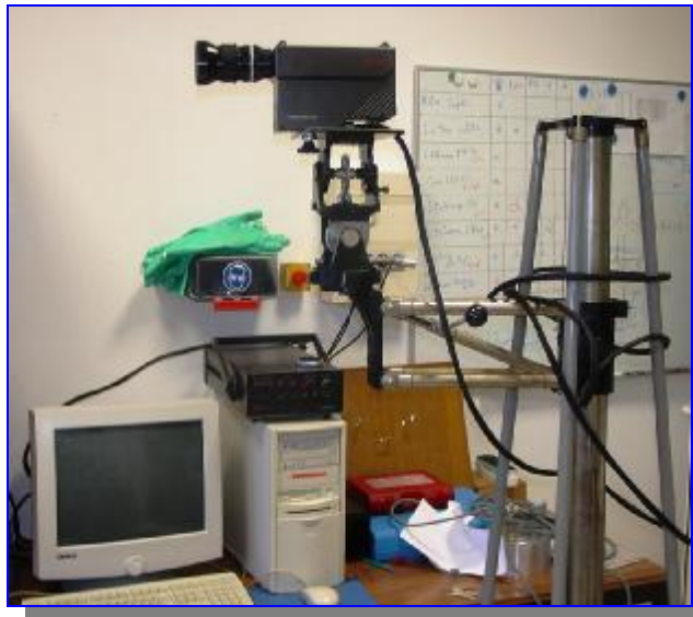
Fig. III.9. Caméra infrarouge de marque ESCIL.
