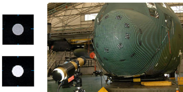
Figure II.11 : utilisation de cible rétro-réfléchissante [8]
