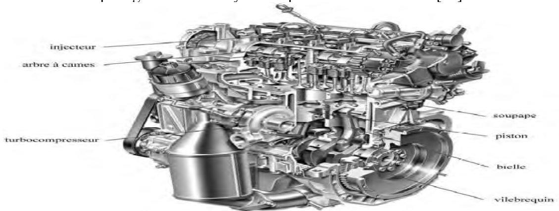
Figure 2.7 : Moteur diesel injection direct à quatre cylindres en ligne
