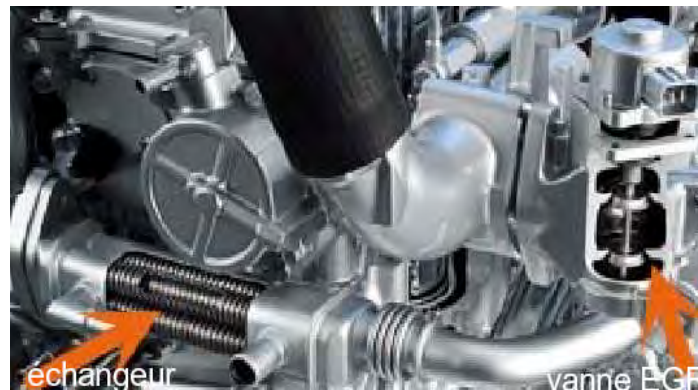
Figure 5.56 : Système d'EGR. (Source : NISSAN) [113]
