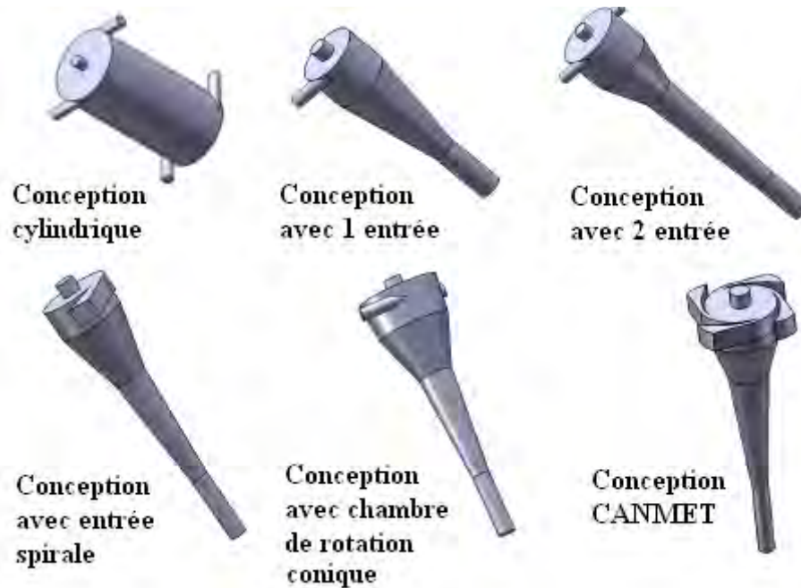
Figure I.4. Evolution de la géométrie de l'hydrocyclone déshuileur
