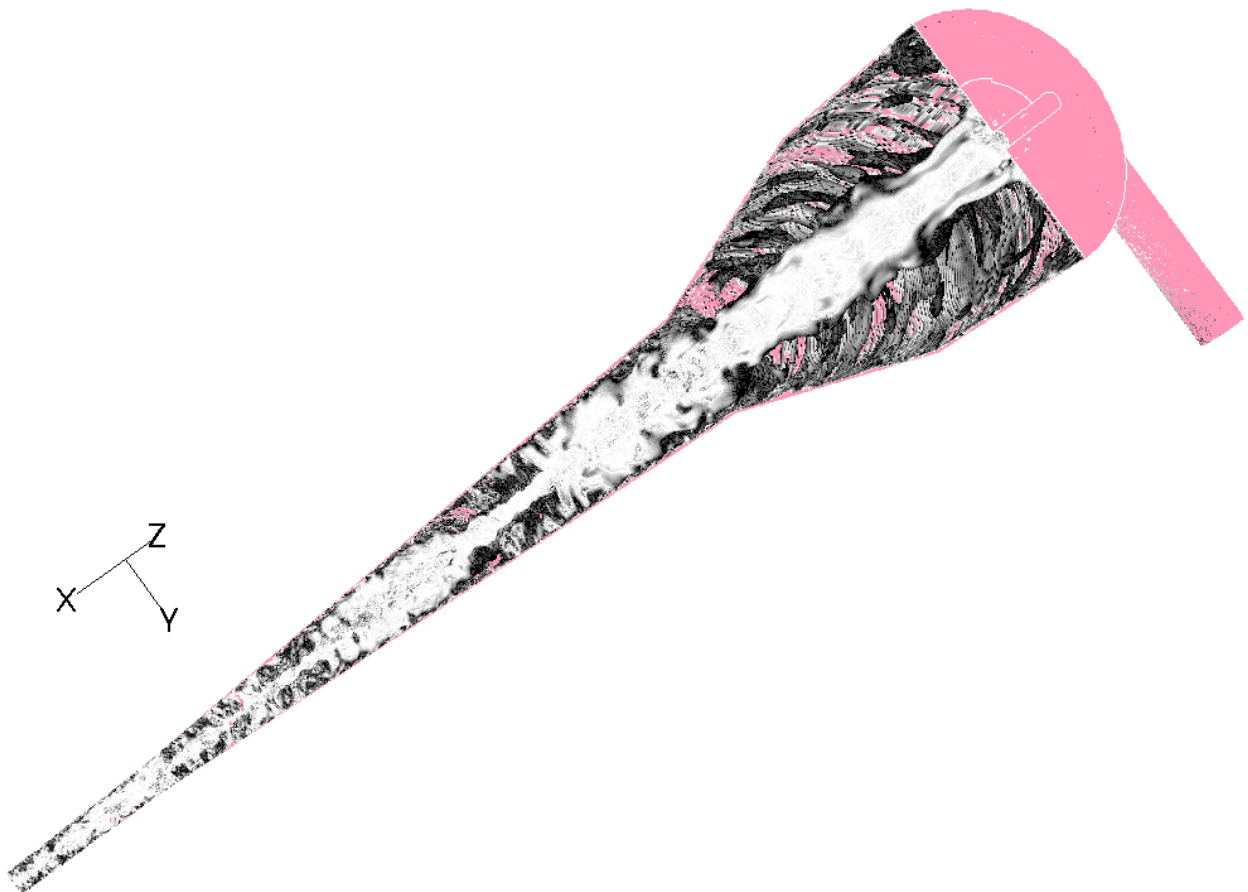
Figure IV.57. Contours de vorticité (1/s) montrant les structures turbulentes dans la partie cylindrique supérieure à t=2.3625 s
