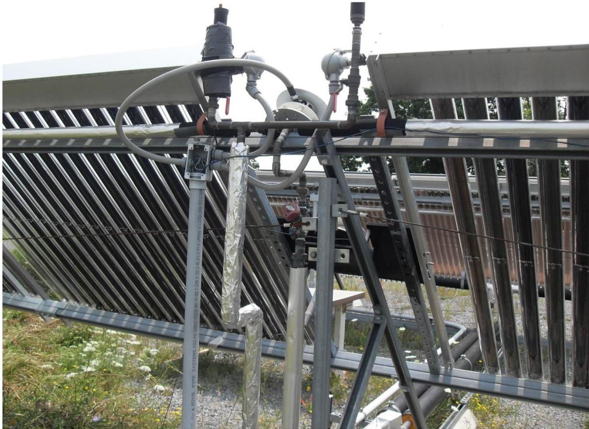
**Figure 3.16 : Sonde de mesure de température**
