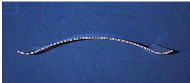
**Figure 3.9 : Détail d'une seule plaque avec canaux internes [61]**
