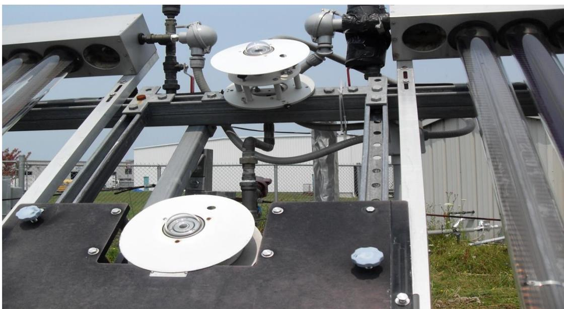
**Figure 3.17 : Pyranomètre sur panneaux solaires**
