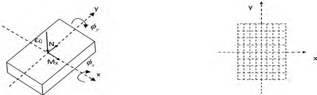
Fig.4.4. Représentation des efforts et des déformations et discrétisation de la section
