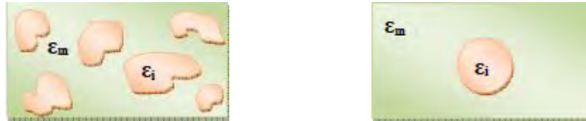
Figure III.1 : Milieu modélisé par Maxwell Garnett dont toutes les inclusions sont ramenées à une inclusion unique : elles sont sans interaction.
