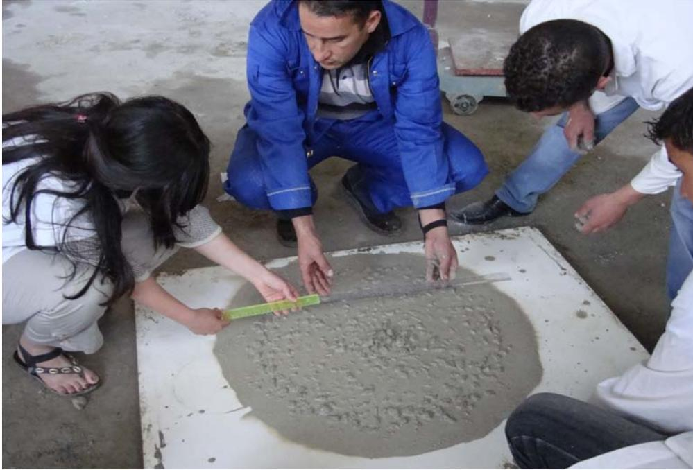
**Figure 4-7 : Essai d'étalement des BAP**
