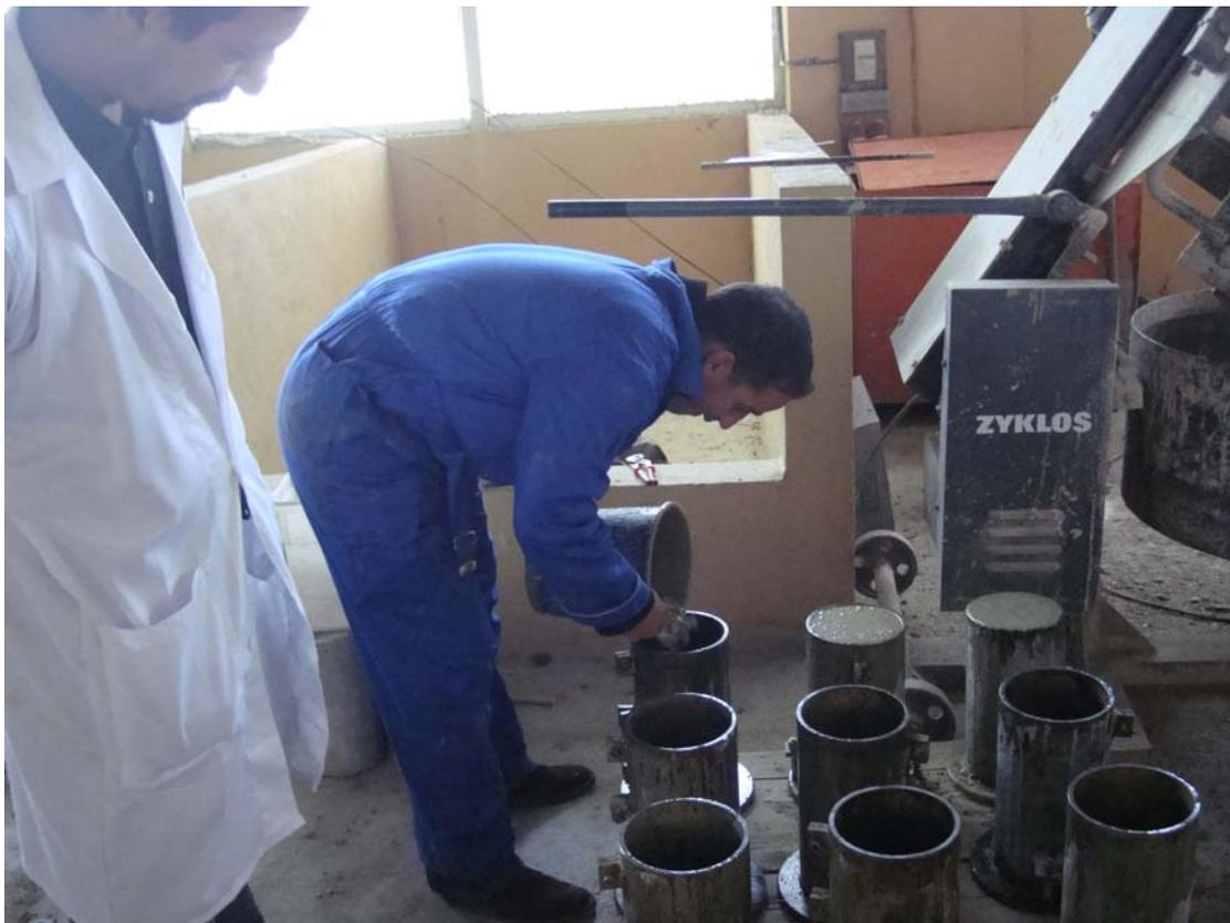
Figure4-6 : Confection des éprouvettes
