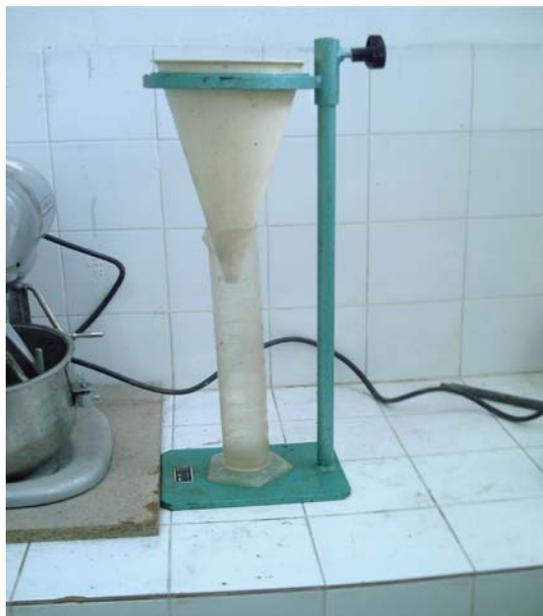
**Figure 4.1 : Essai au cône de Marsh.**
