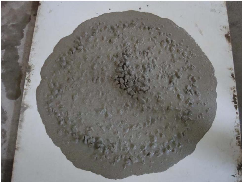
**Figure 4-8: Essai d'étalement des BAP**
