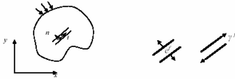
Figure 3.12 : Domaine fissuré et état de déformation de la fissure
