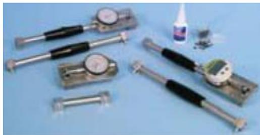
*Figure 1.8: l'extensomètre*
