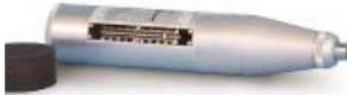
*Figure 1.1: le scléromètre*
