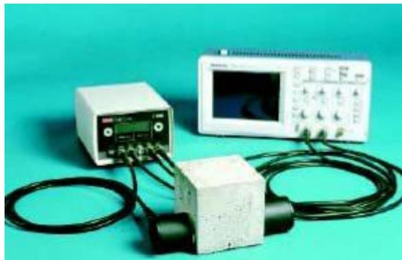
*Figure 1.2: appareil d'auscultation par ultrasons*
