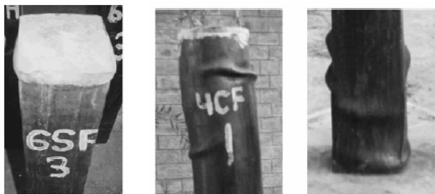
Figure 3.1 : Modes de ruptures des spécimens des poteaux mixtes de section carré et circulaire [13]
