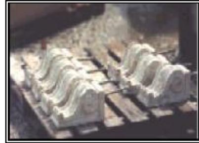
Fig. 2.29. brise-lame renforcé de fibre
