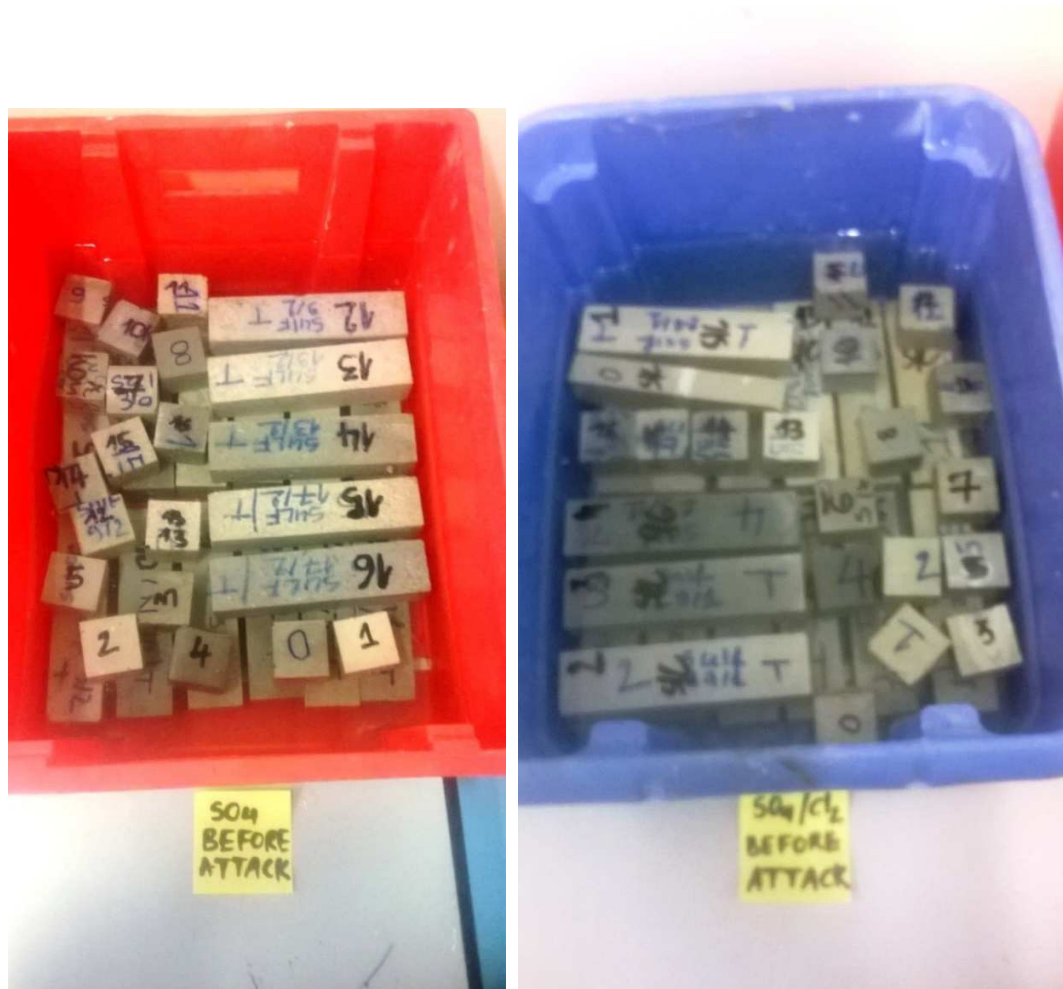
Figure 38 - Éprouvettes de mortier immergées dans les solutions chimiques.
