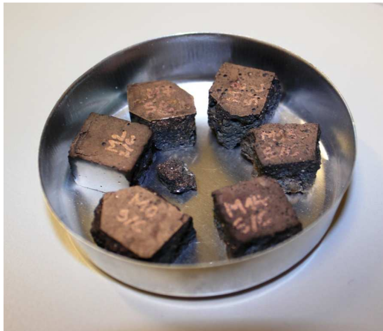
Figure 32 - Échantillons métallisés à l'or pour les observations microstructurelles de la morphologie au MEB.
