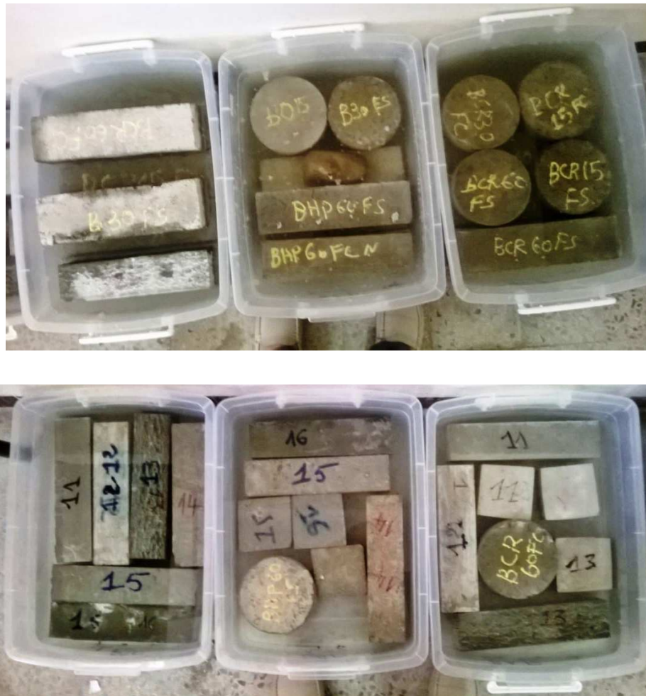
Figure 31 - Immersion des échantillons de bétons dans les solutions de sulfates et sulfates/chlorures.
