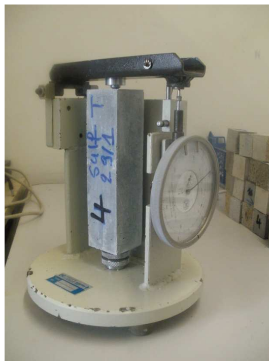
Figure 37 - Appareil de mesure de changement de longueur des échantillons de mortier.
