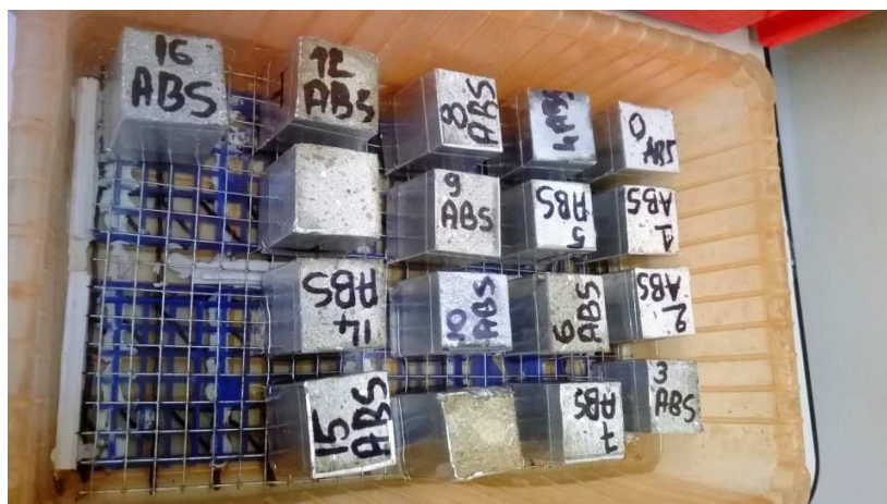
Figure 36 - Essais d'absorption capillaire pour éprouvettes de mortier.
