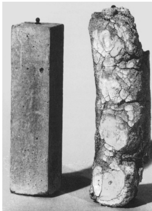
Figure 15 - L'attaque sulfatique classique associée à la formation d'ettringite (source : Réf. 42 )
