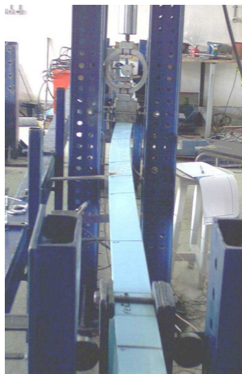
Figure 1.12. Déversement d'une poutre cellulaire [10]
