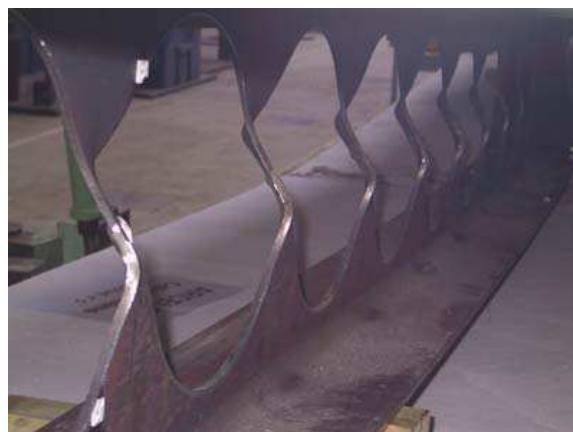
Figure 1.11. Flambement du montant [6]
