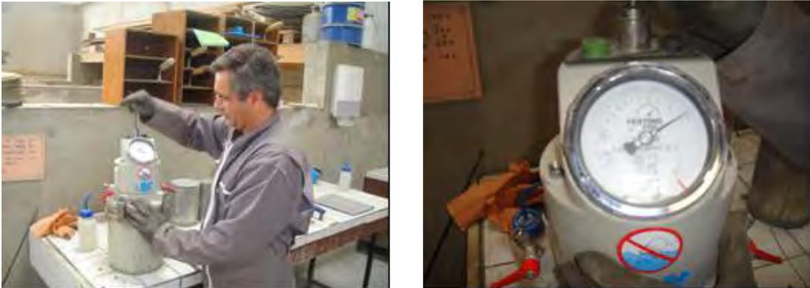
**Figure 5.2.** Test de l'air occlus
