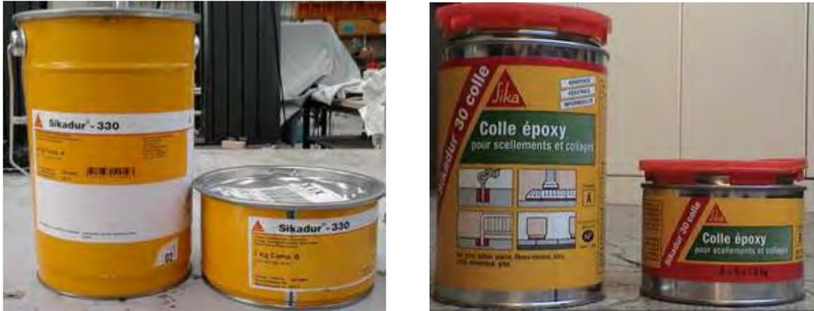
**Figure 5.7.** Résine utilisée dans les renforts
