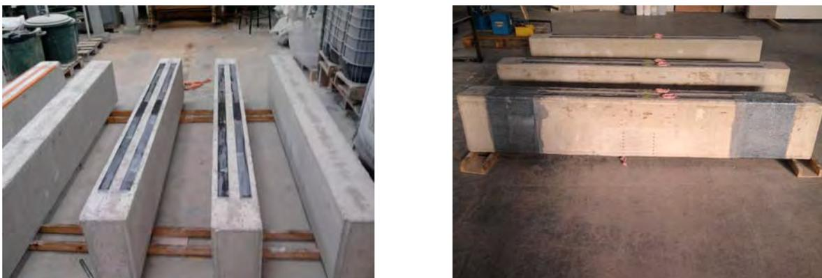
Figure B.5 Mise en place du renfort
