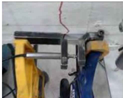
**5 b**: LVDT pour mesure de la fissuration
