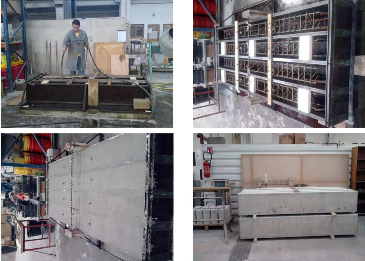
**Figure 5.9. Différentes étapes de réalisation de spécimens**
