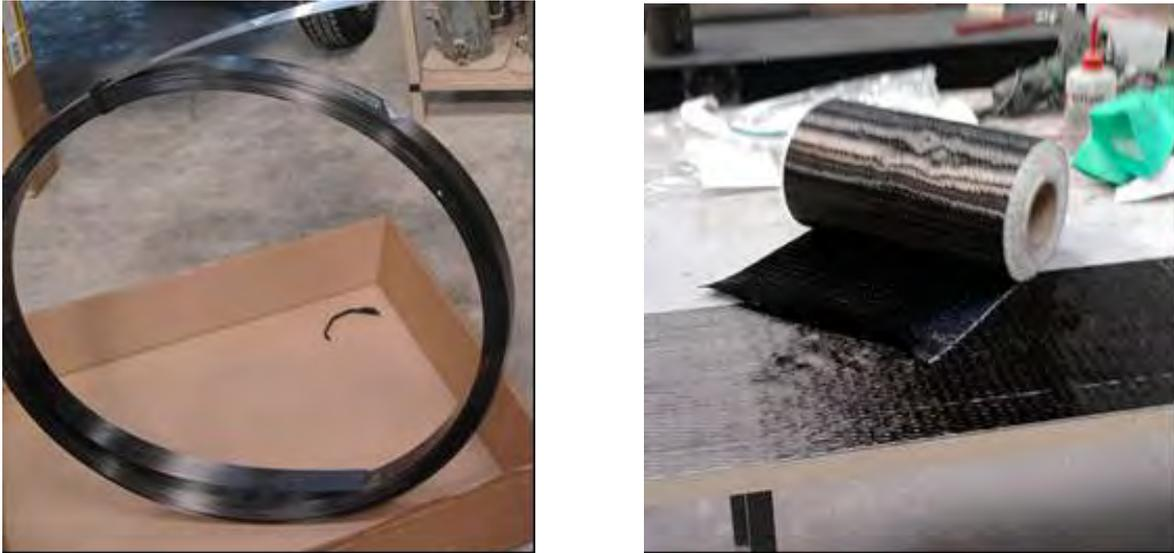
**Figure 5.6.** Lamelle et tissu en PRFC
