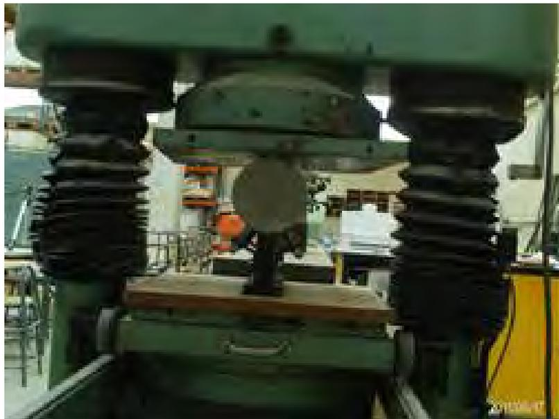
*Figure 5.4. Essai à la traction par fendage*
