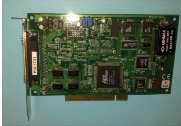
Photo 4.8 : Carte multifonction utilisée dans les essais.
