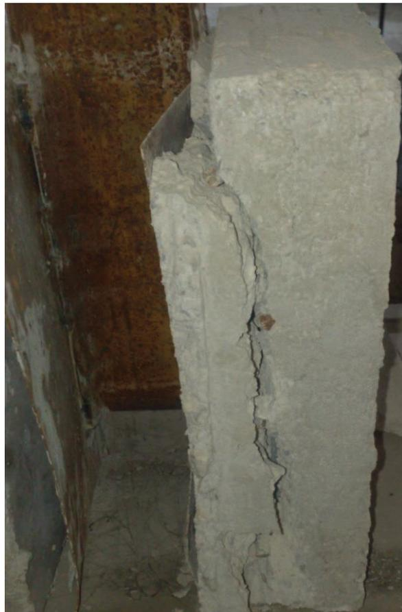
*Photo 5.9 : Ruine par éclatement longitudinal de la dalle de béton.*
