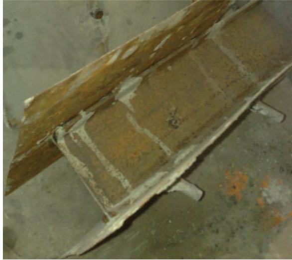
*Photo 5.8 : Ruine par rupture du connecteur en goujon.*
