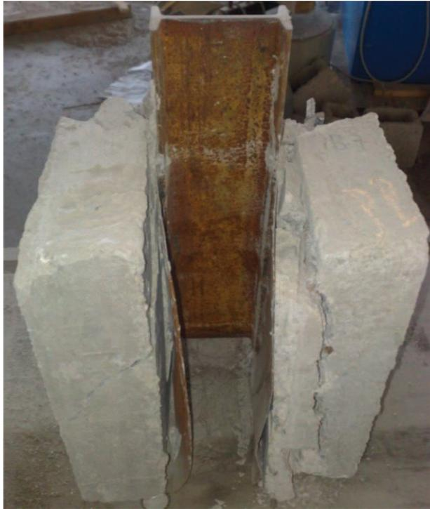
*Photo 5.2 : Ruine par écrasement du béton autour du connecteur en plaque perforée.*
