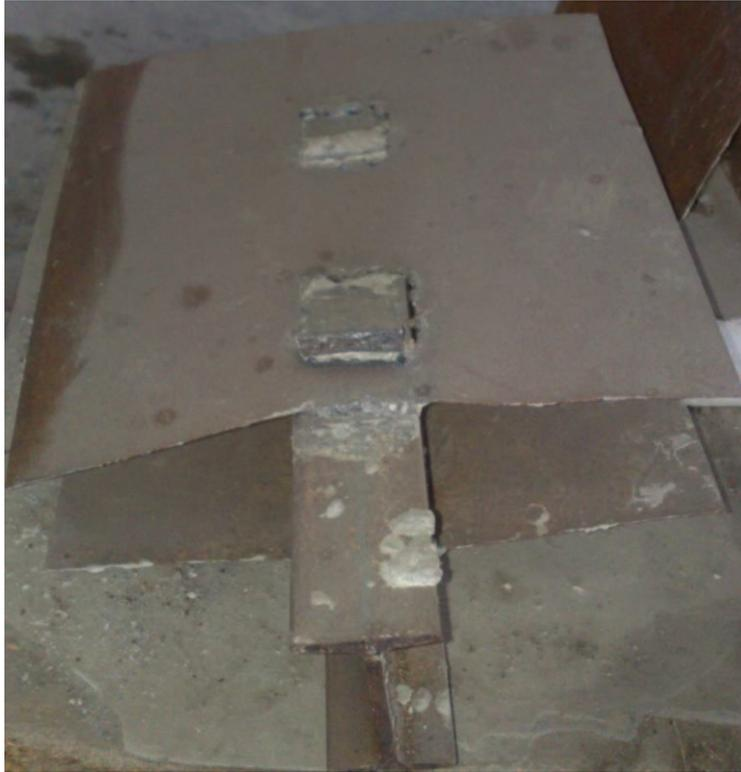
*Photo 5.4 : Ruine par rupture et déformation excessive du connecteur en cornière.*
