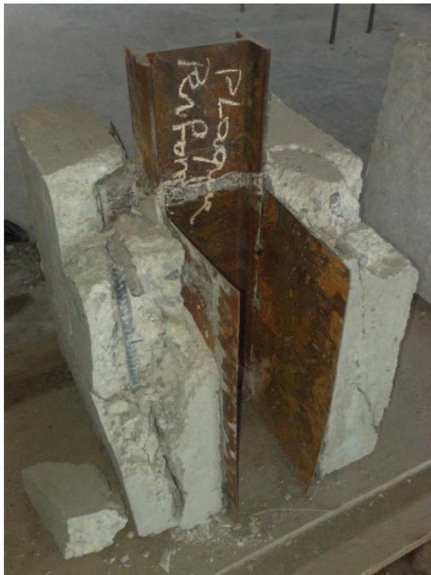
*Photo 5.3 : Ruine par éclatement du béton le long de la dalle de béton.*
