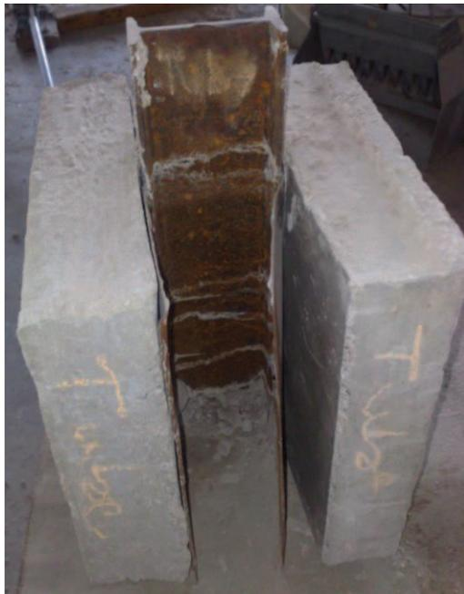
*Photo 5.1 : Ruine par rupture du béton au niveau du connecteur.*
