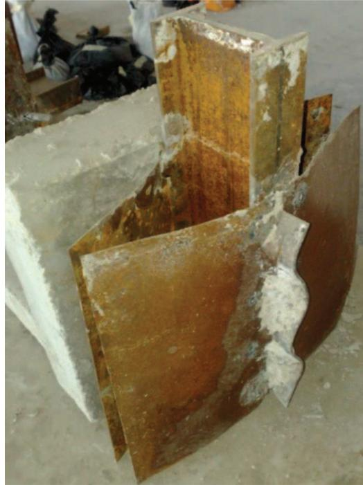
*Photo 5.6 : Ruine par rupture de la liaison cas du connecteur en tôle ondulée.*
