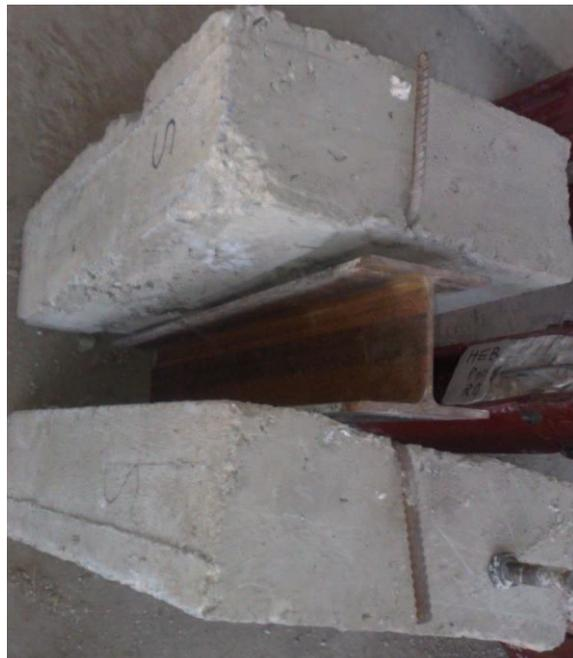
*Photo 5.11 : Ruine par glissement excessif à l'interface cas du connecteur en S.*
