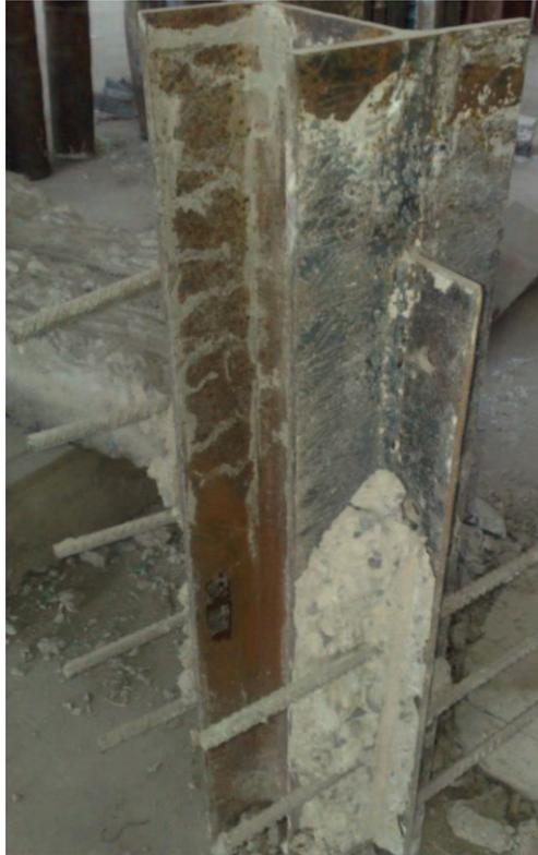
*Photo 5.10 : Ruine par écrasement du béton du connecteur en plaque perforée.*
