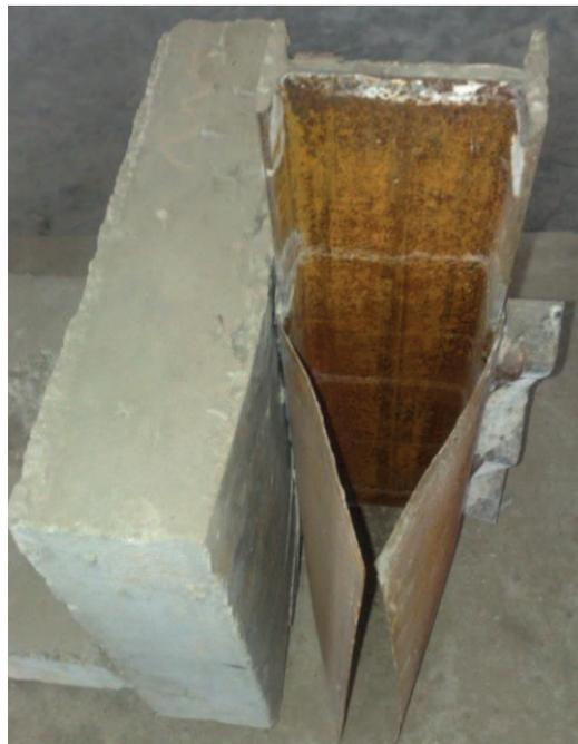
*Photo 5.7 : Ruine par rupture de la liaison d'un seul côté cas du connecteur en tôle ondulée.*
