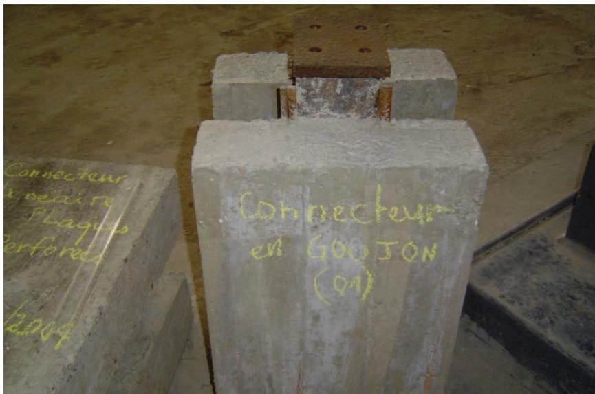
Photo 4.5 : Eprouvette finalisée avec dalles de béton.
