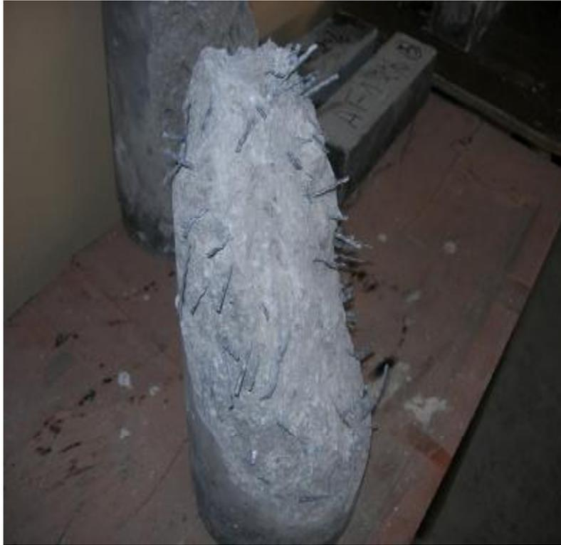
**Fig : 1.2 Surface de rupture d'un béton renforcé de fibres métalliques**
