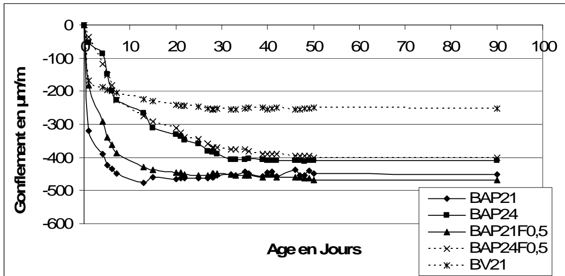
Figure IV.11 : Gonflement des bétons étudiés dans le milieu immergé.
