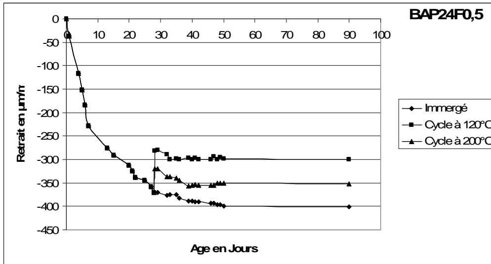
Figure IV.29. : Effet d'un cycle de chauffage provoqué à l'âge de 28 jours sur l'évolution du retrait du BAP24F0,5 conservé dans un mode immergé.
