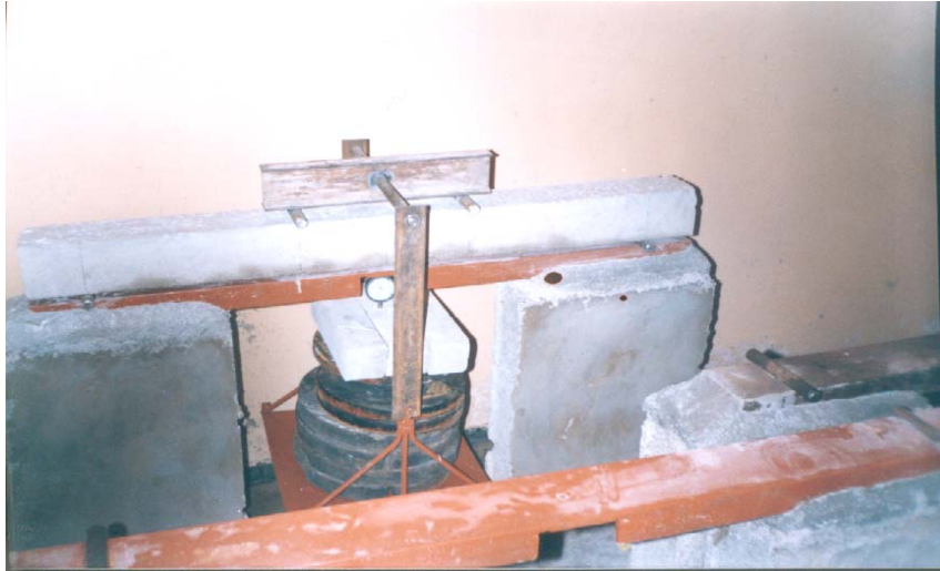
Figure IV.15. Dispositif utilisé pour la mesure du fluage en flexion [23]
