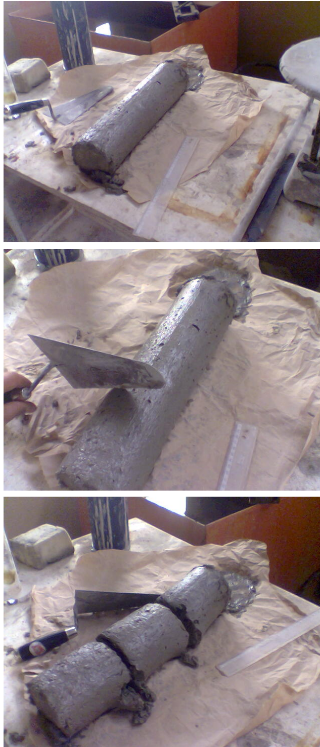
Figure III.4. Les différentes étapes de l'essai de mesure de l'indice de ségrégation statique. [13][14].
