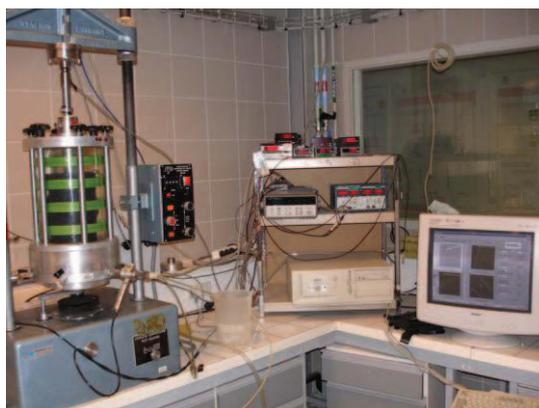
Fig. 1.6: Modèle d'appareillage d'essai triaxial classique.
