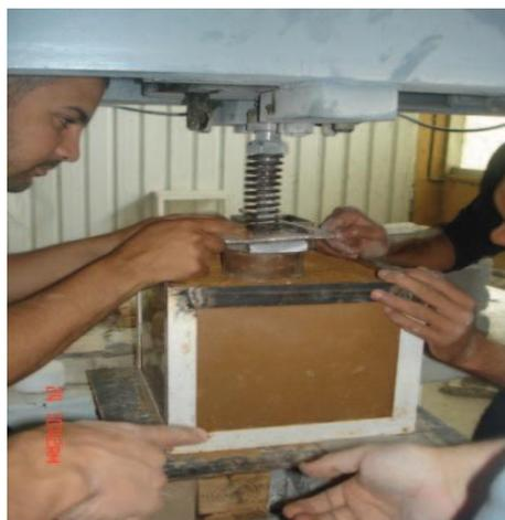
Fig. 4.4 : mise en place du dispositif de la force.
