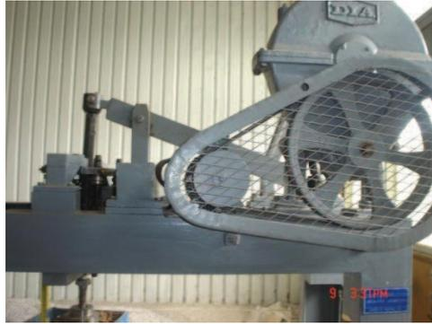
Fig.4.3: Système poulies de transmission relié au variateur de vitesse.
