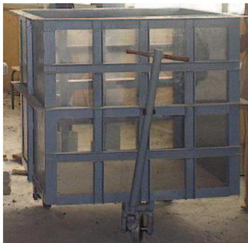
Fig. 4.7 : bac d'essai cubique – volume de sol 1m<sup>3</sup>
