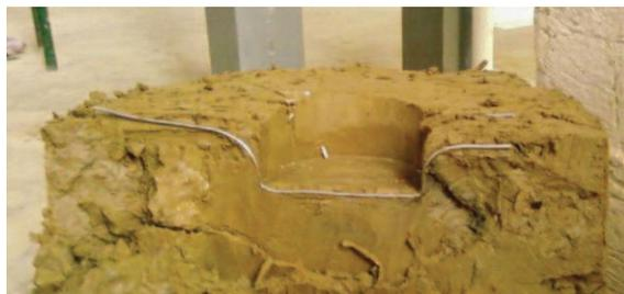
Fig. 5.28 : Rupture par enfoncement de l'argile sous des sollicitations cycliques
