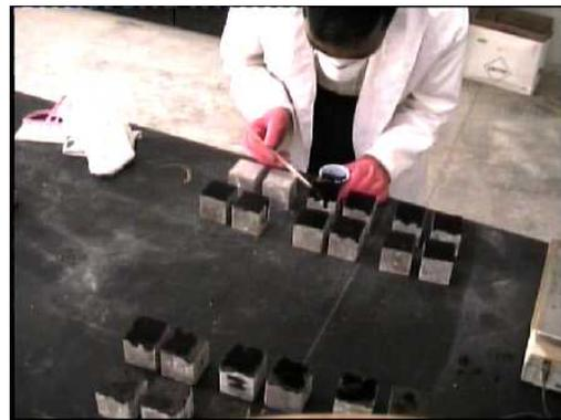
Figure 3.28: Coloration des éprouvettes
