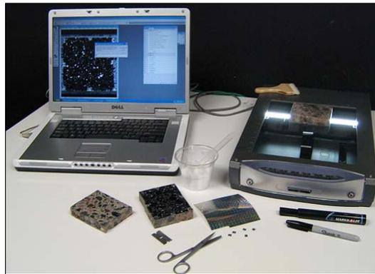
Figure 3.26: Instruments nécessaires pour la méthode du scanner [78]
