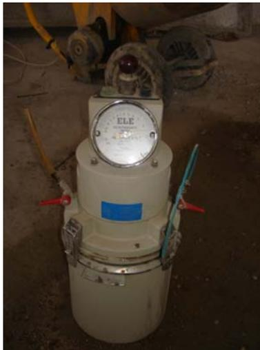
Figure 3.3 Aéromètre à béton
