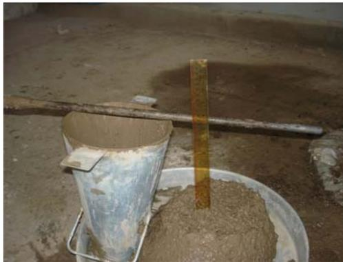
Figure 3.2 Affaissement au cône d'Abrams
