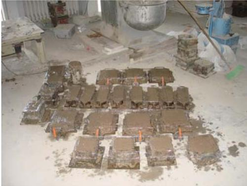
Figure 3.7. Conservation des éprouvettes
