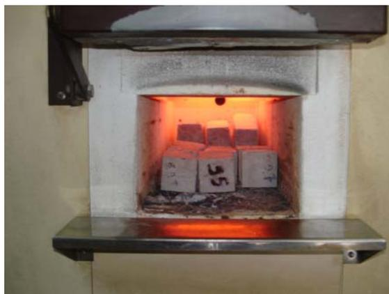
Figure 4.15. Epreuves cubiques à durant le chauffage.
