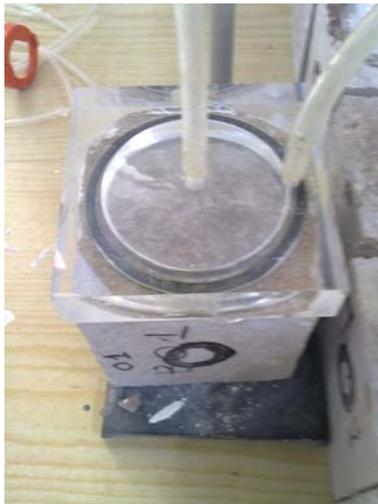
Figure 3.14. Cellule du system ISAT
