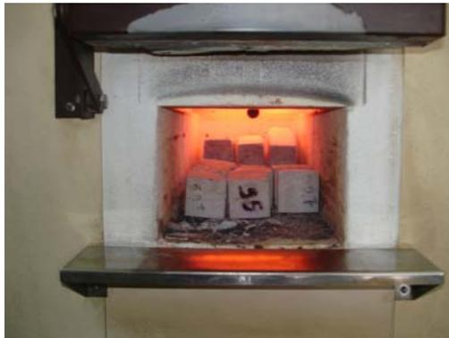
Figure 3.24, Eprouvettes à l'intérieur du four durant le chauffage à  $500. ^{\circ}\text{C}$
