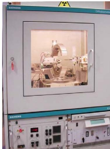
Figure 3.21. Diffractomètre D 5000
