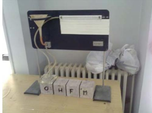
Figure 3.13 le système d'essai ISAT
