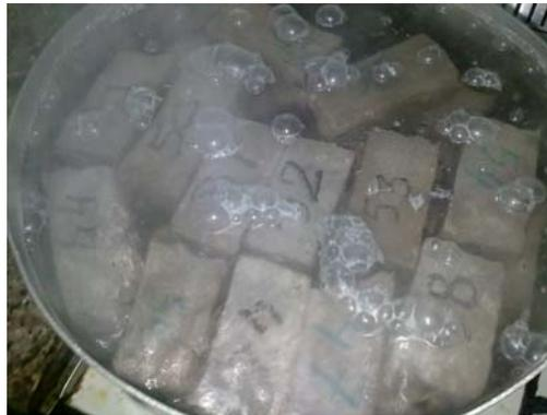
Figure 3.16. Cuisson des éprouvettes dans l'eau
