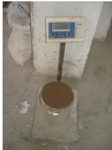
Figure 3.4. Mesure de la densité réelle
