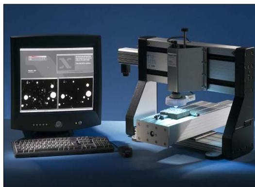
Figure 3.25: The Rapid Air 457. Le système d'analyse automatique de l'air occlus
