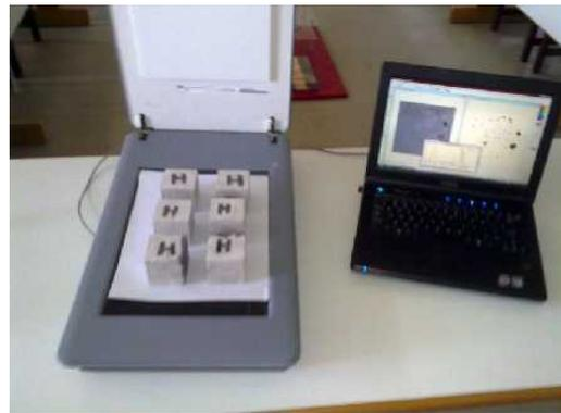
Figure 3.30: Scanner des éprouves
