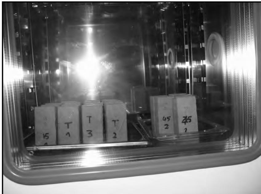
**Figure 3.6.** Conservation des éprouvettes à  $HR = 50 \pm 5 \%$  et  $T^{\circ}20^{\circ}$  Jusqu'à 7 Jours d'âge
