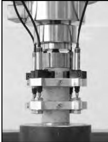
**Figure 4.4** Photo du dispositif expérimental avec 4 LVDT maintenus entre 2 anneaux
