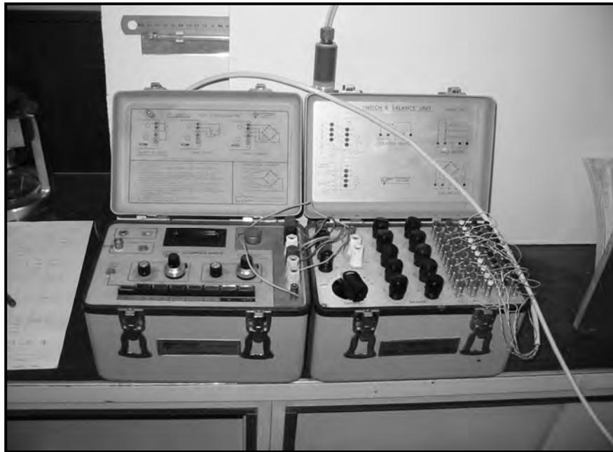
Figure 4.14 photo du matériel à mesurer les déformations (pont de jauges)
