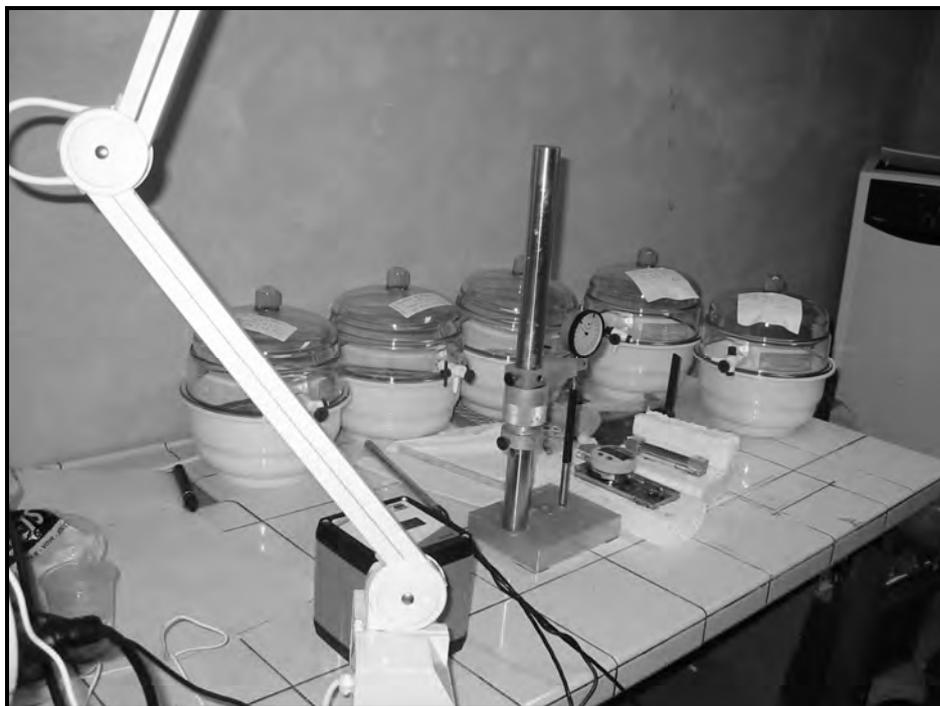
**Figure 5.10** Appareils de mesure du retrait (rétractomètre) et dessiccateur ayant servis à la conservation des échantillons à hygrométrie contrôlée
