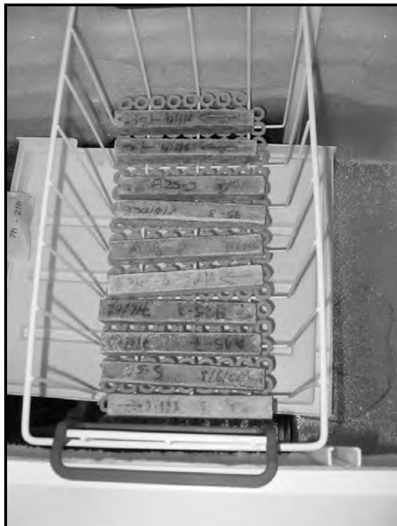
**Figure 5.13** Photo de conservation des échantillons de mortier (Primes  $2 \times 2 \times 16 \text{ cm}^3$ ) dans le congélateur
