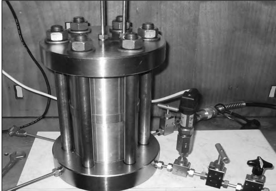
**Figure 4. 12** *Photo de la cellule hydrostatique*
