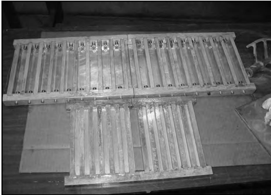
**Figure 5.9** Photos des moules ayant servis à la confection des prismes  $2 \times 2 \times 16$  cm<sup>3</sup>
