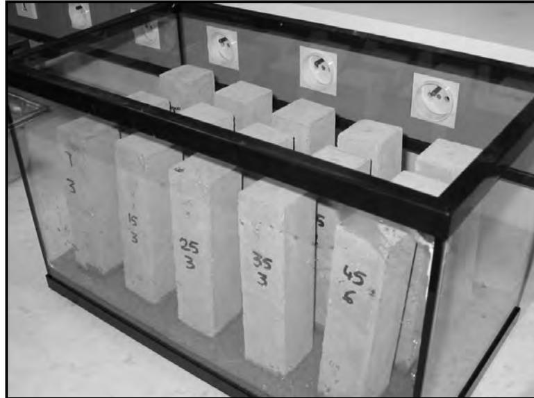
**Figure 3.7** Conservation des échantillons dans le récipient contenant 2 cm de sable siliceux 0/0.5 gorgé d'eau (mesure d'absorption capillaire).
