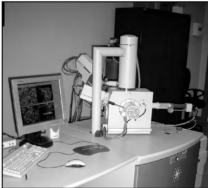
**Figure 3.10** Photo Microscope électronique à balayage environnemental (Quanta 200) de la FR 1818)
