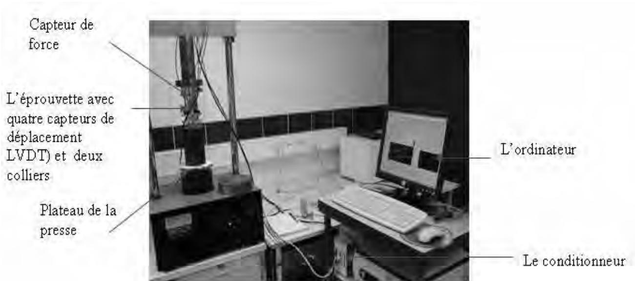
Figure 4.5 Vue générale de l'équipement d'essai mécanique
