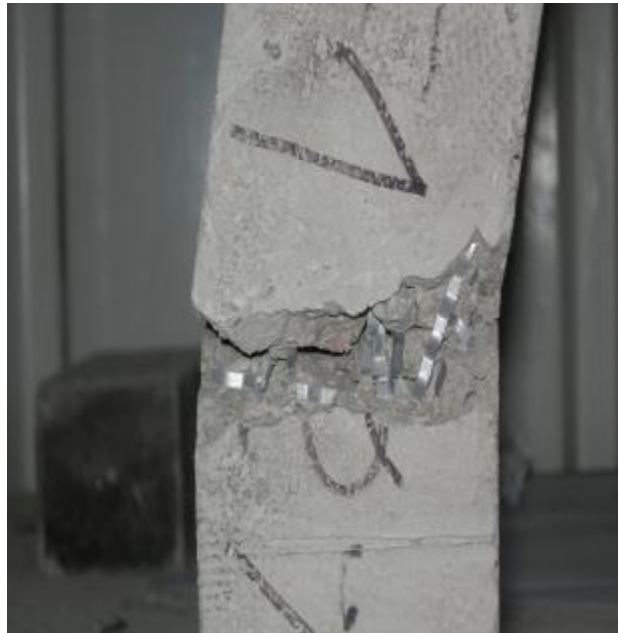
Photo 1 : Rupture d'une éprouvette renforcée de fibres industrielles
