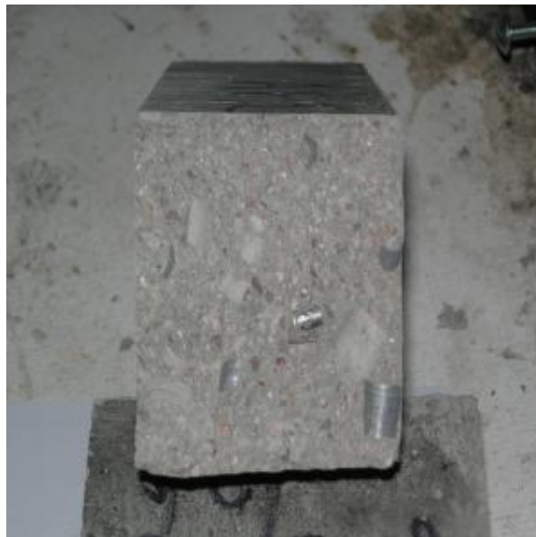
Photo 2 : rupture d'une éprouvette renforcée de copeaux industriels BSP
