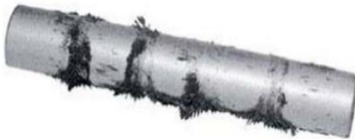
Figure I.1. Tube magnétique à aimant permanent (ferrites, terres rares) Eriez magnetic
