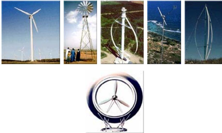
Figure I-7 : Différents types d'éoliennes.
