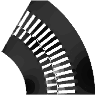
Fig.IV.2 Dégradé de l'induction.
