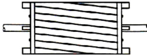
Fig.II.9. La disposition en biais des barres rotoriques.
