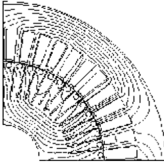
Fig.III.38. Ligne isovaleurs de l'induction « cage dissymétrique »
