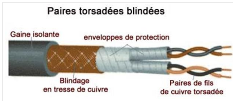
Figure 1.5: Paire torsadée blindée.
