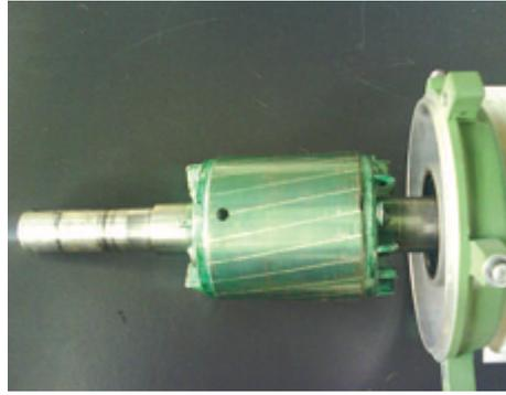
Figure 1.6. Simulation d'une rupture d'une barre rotorique.
